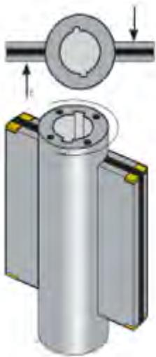
旋转叶片系统模型是理想的转矩输出配置，所产生的力矢量作用于叶片上总是平行的，正反方向的大小相等
